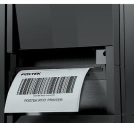
先打印后读写校验的天线设计，可完全检测所有不良标签。
